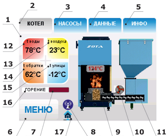
Рис.9 Расположение органов управления и индикации на передней панели пульта
